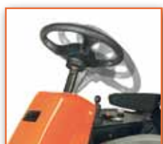
Sklopný nastavitelný volant pro komfort operátora
