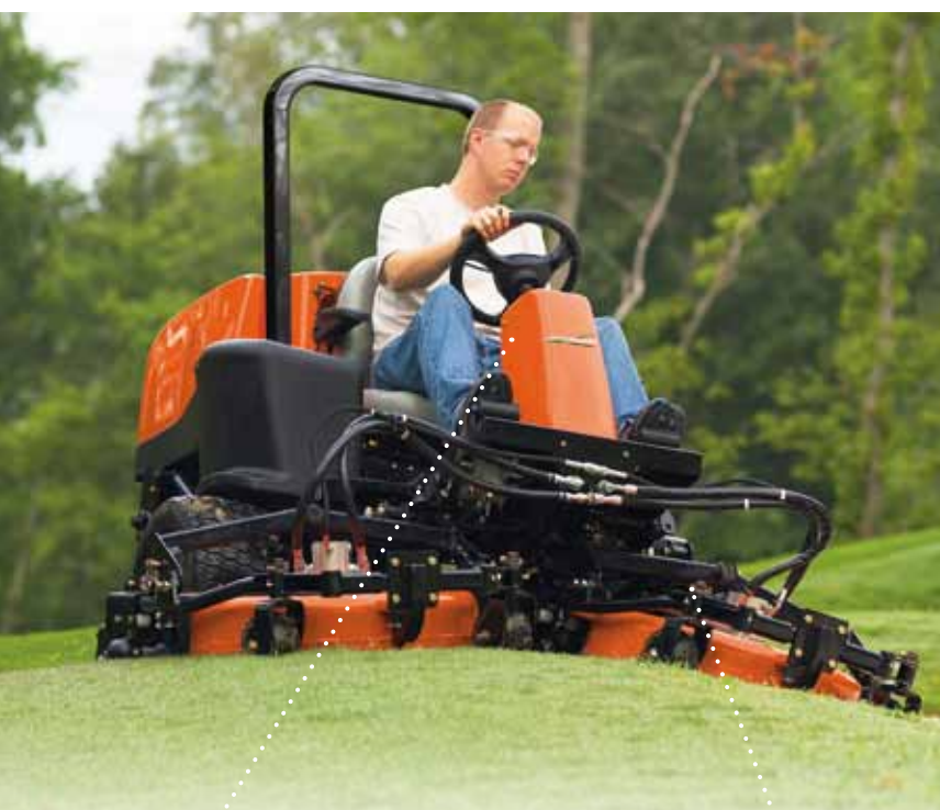
Ergonomicky uspořádané pracoviště operátora přístupné z levé i pravé strany
